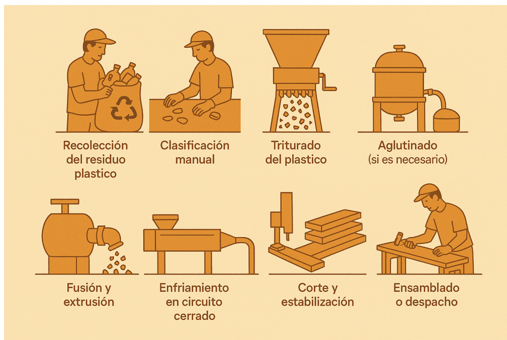
Figura 12. Proceso de fabricación de la madera plástica.
